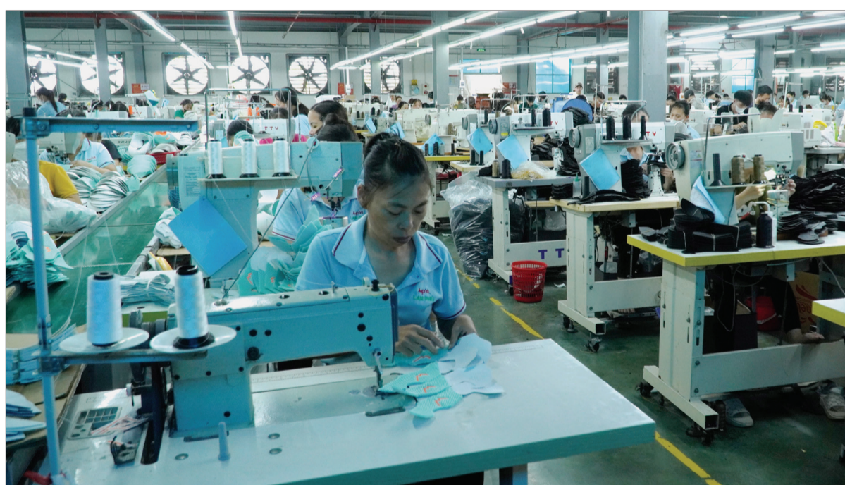
Công ty TNHH Sản xuất và Thương mại bảo hộ Lan Phú sử dụng hệ thống chiếu sáng bằng đèn led và quạt âm tường đối lưu không khí để làm mát nhà xưởng.
