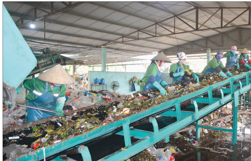
Công nhân phân loại rác thải tại nhà máy xử lý rác thải sinh hoạt Quỳnh Côi (Quỳnh Phụ).
