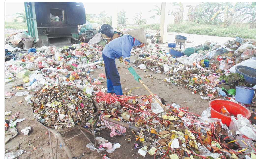
Rác thải sinh hoạt được phân loại trước khi đưa vào lò đốt.
