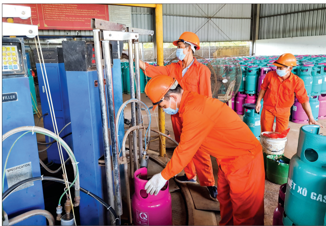
Hệ thống chiết nạp gas hiện đại giúp doanh nghiệp giảm hao hụt nguyên liệu và cải thiện môi trường làm việc của người lao động.
