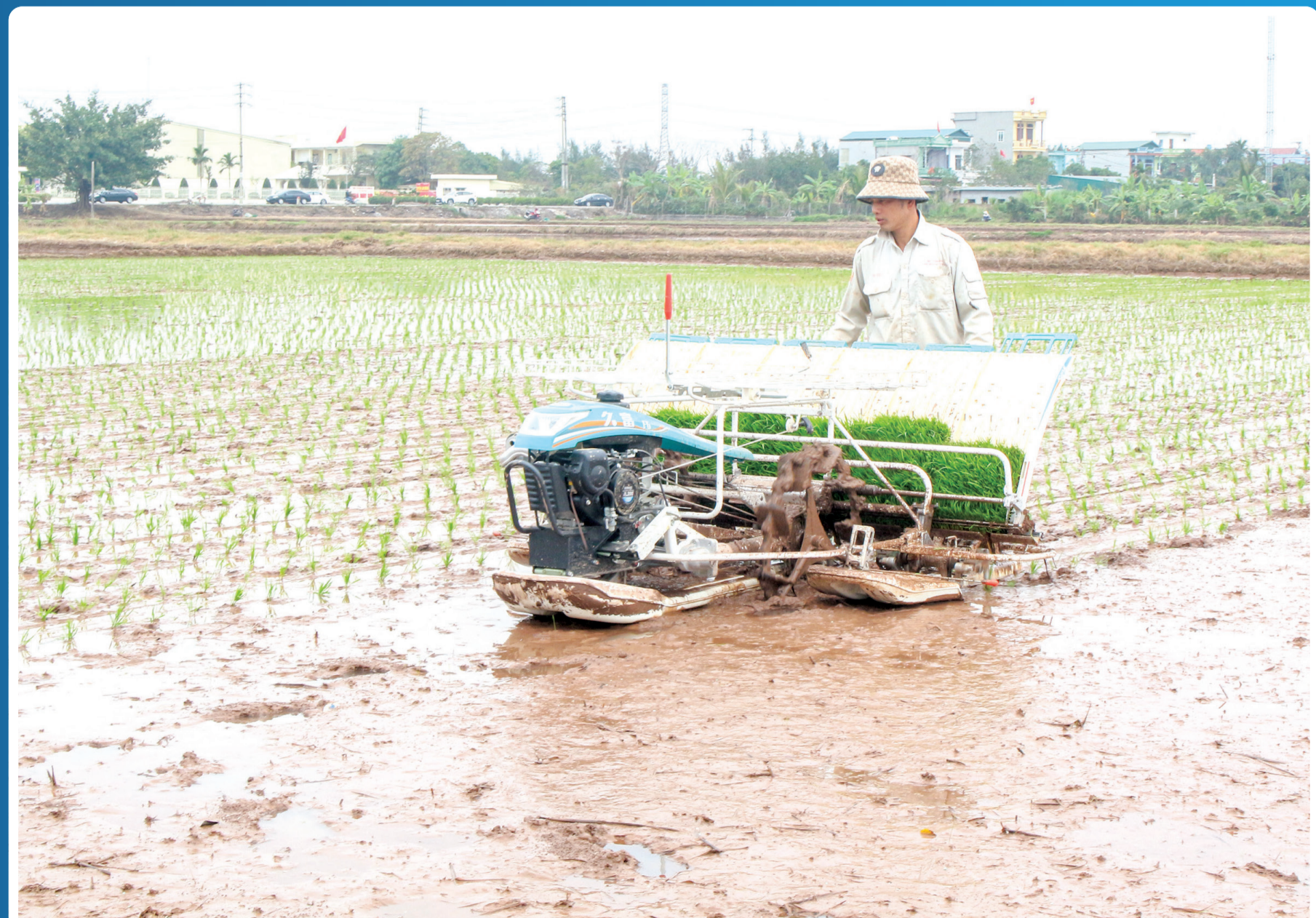
Sử dụng máy cấy, gia đình anh Nguyễn Tất Hà, thôn Vĩnh Ninh, xã Đông Tân (Đông Hưng) cấy 10 mẫu ruộng chỉ mất từ 2 - 3 ngày.
