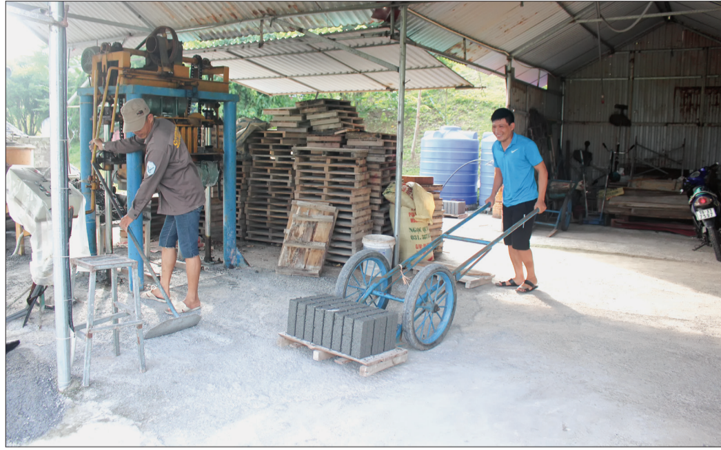
Chùa Long Hưng, xã Nam Hưng, huyện Tiên Hải đầu tư máy sản xuất gạch không nung hỗ trợ gạch xây nhà đại đoàn kết cho nhiều hộ nghèo.
