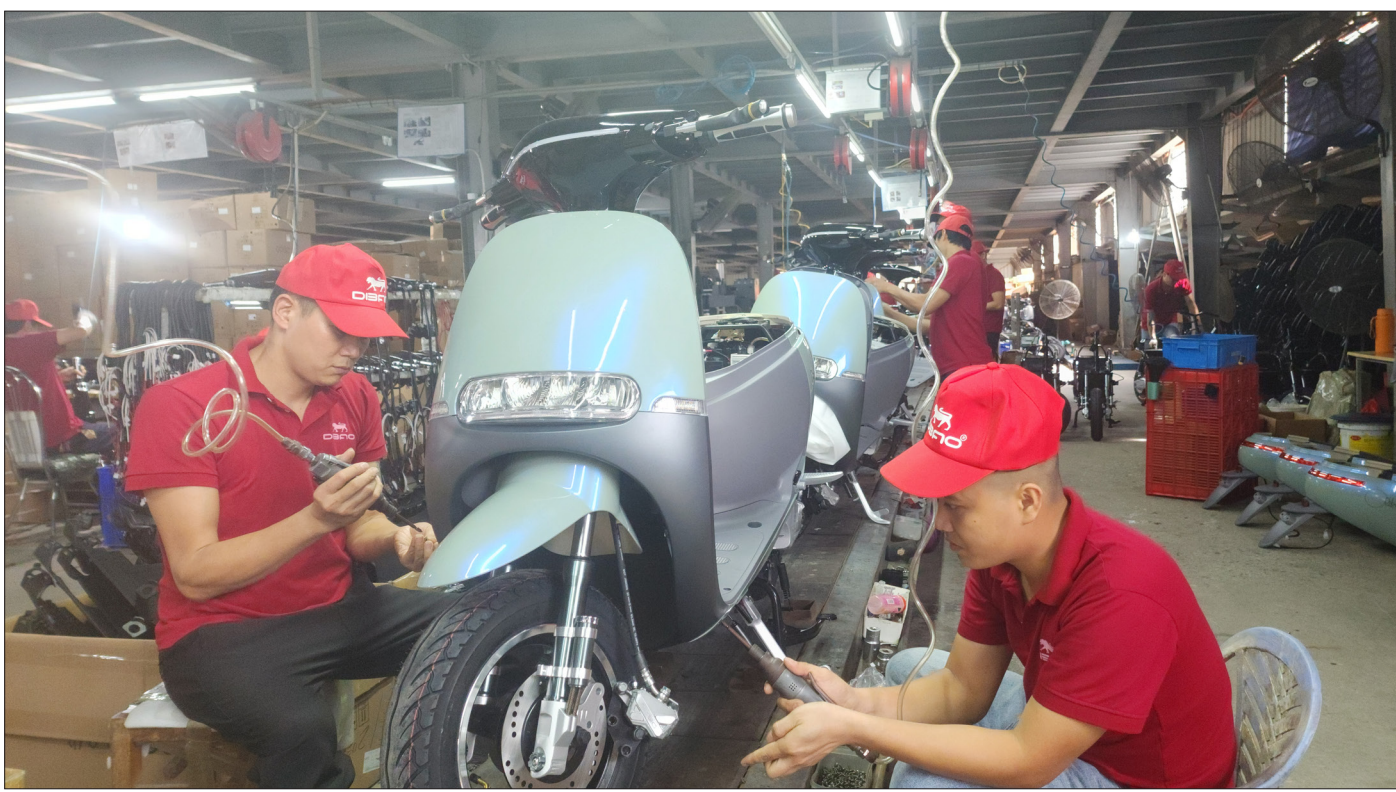
Dây chuyền lắp ráp xe máy điện của Công ty TNHH thương mại Tấn Thành (khu công nghiệp Phúc Khánh, thành phố Thái Bình).
