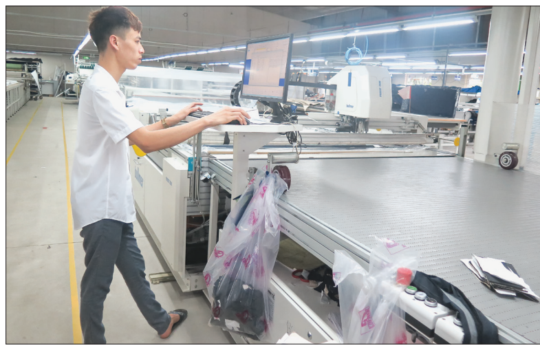
Lập trình máy cắt tự động trên hệ thống máy tính ở Xí nghiệp Veston Hưng Hà.
