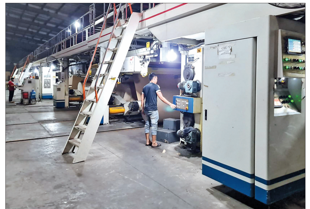
Đây chuyên máy ép tạo tấm bia carton của Công ty TNHH Phúc Kiến được đầu tư mới và sử dụng nhiều công nghệ tiết kiệm điện.
