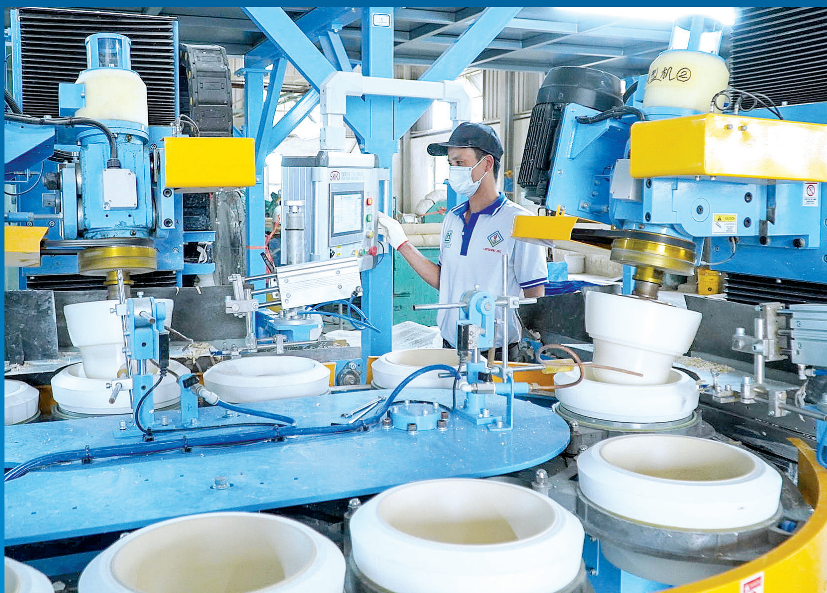
Công ty Cổ phần Gốm sứ Long Hâu đầu tư robot tự động sản xuất sản phẩm sứ dân dụng.
