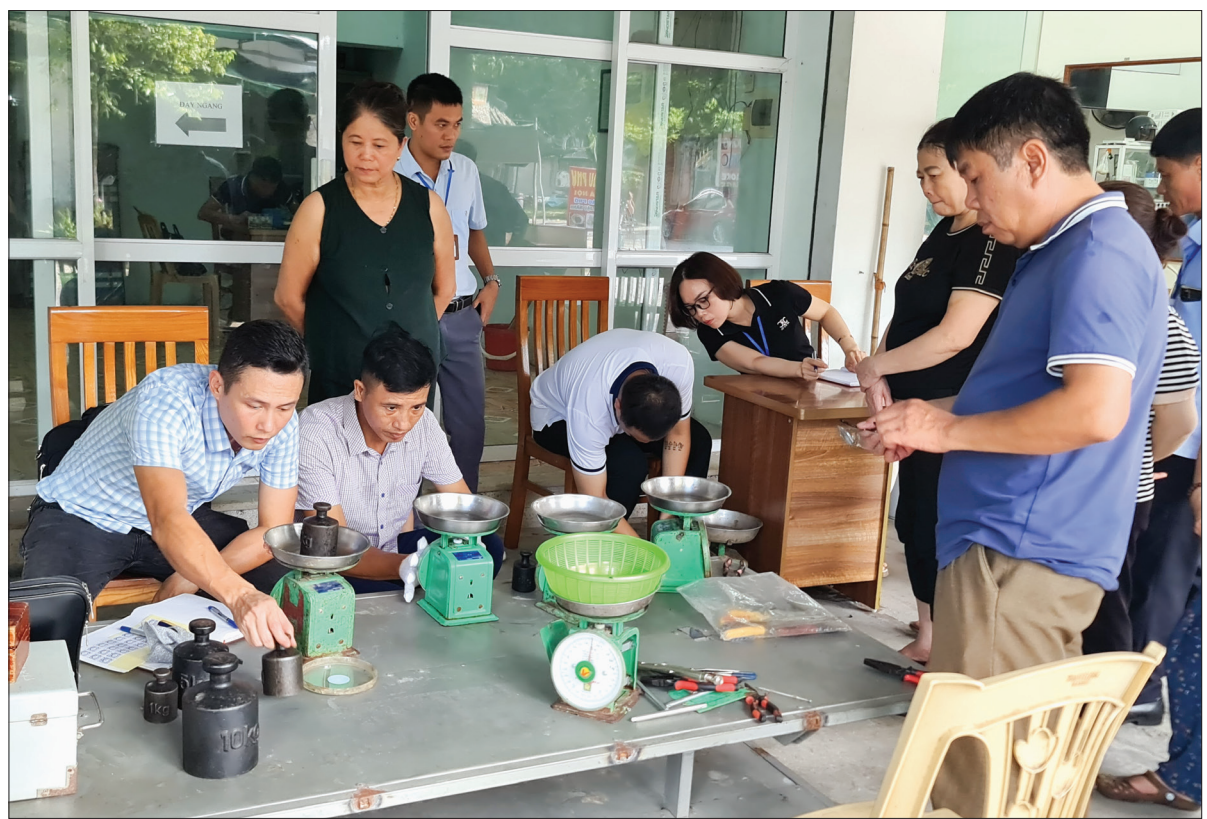
Các kỹ thuật viên Trung tâm Ứng dụng thông tin khoa học công nghệ và đo lường thử nghiệm thực hiện hiệu chỉnh, kiểm định cân cho tiểu thương chợ thị trấn Đông Hưng.
