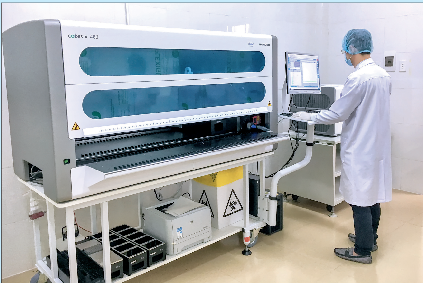
Hệ thống xét nghiệm sinh học phân tử Realtime-PCR tự động Cobas 4800 tại Trung tâm Kiểm soát bệnh tật tỉnh.
