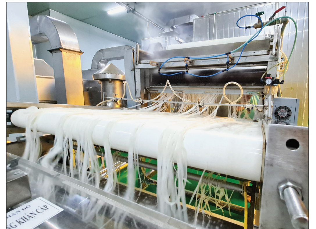
Sợi phở được chế biến hoàn toàn tự động bằng máy móc hiện đại công nghệ Nhật Bản, Hàn Quốc.
