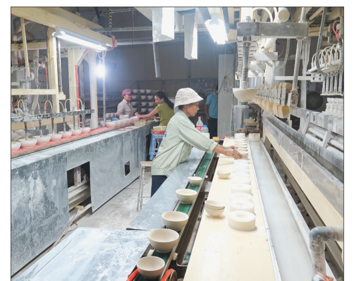
Công đoạn tráng men của Công ty đã được thực hiện bằng máy móc hiện đại.
