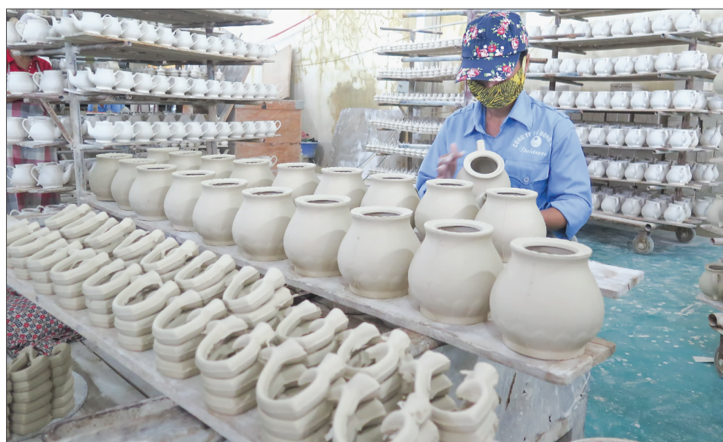
Công đoạn chỉnh sửa, tô vẽ, hoàn thiện sản phẩm mộc sứ dân dụng, mỹ nghệ.
