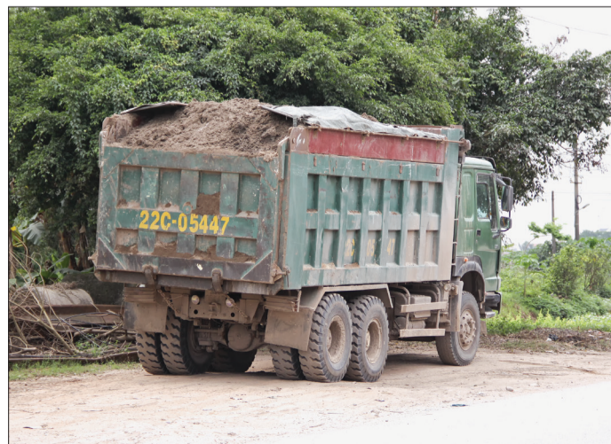
Đại đa số các phương tiện chở vật liệu xây dựng đi trên tuyến đường ĐT.458 đoạn qua địa phận xã Tây Lương (Tiên Hải) đều coi nới thành thùng và chở hàng vượt quá tải trọng cho phép.
