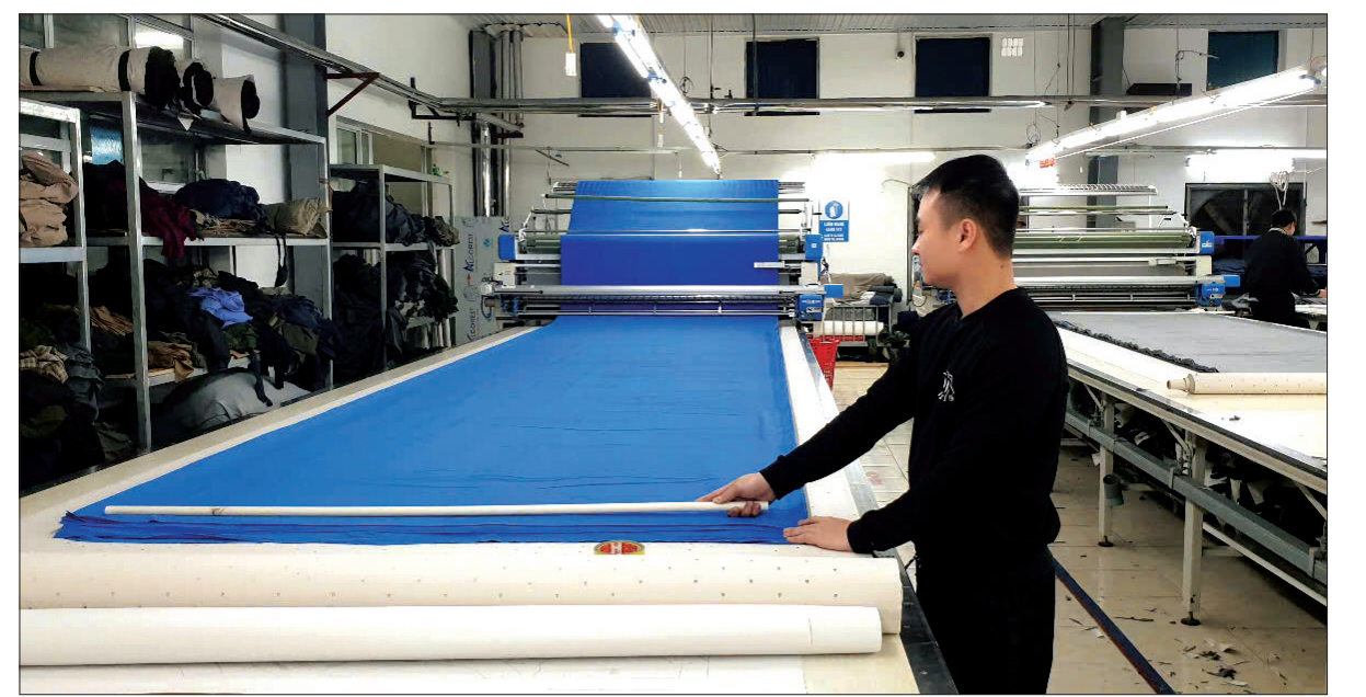
Công ty Cổ phần May HNF đầu tư hệ thống máy trải vải tự động để nâng cao sản lượng, giảm sức lao động.
