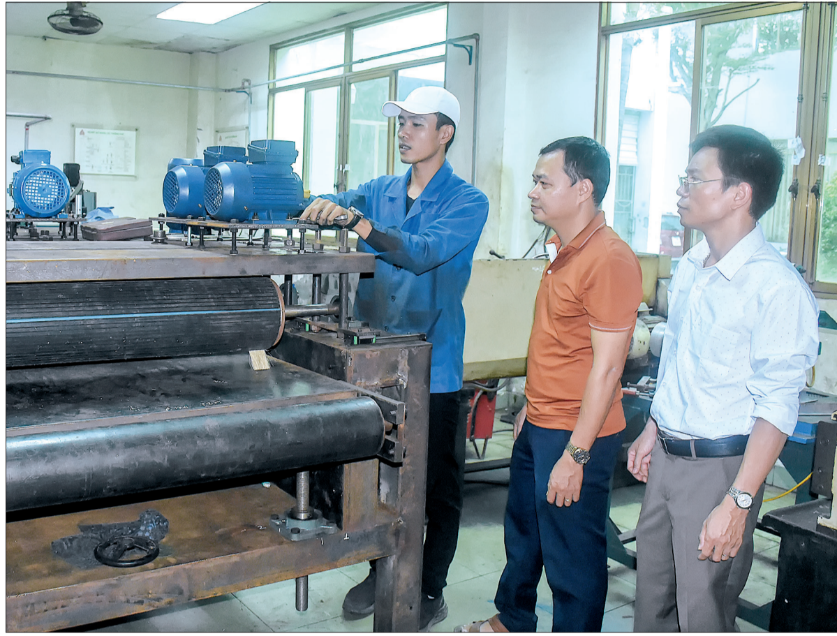
Sinh viên Trường Đại học Thái Bình chế tạo máy chà nhám sản phẩm gỗ phục vụ nhu cầu của doanh nghiệp.
