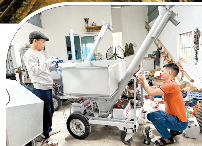
Anh Chu Sỹ Dụng (người bên phải) lắp ráp, chế tạo máy cho gà ăn tự động.
