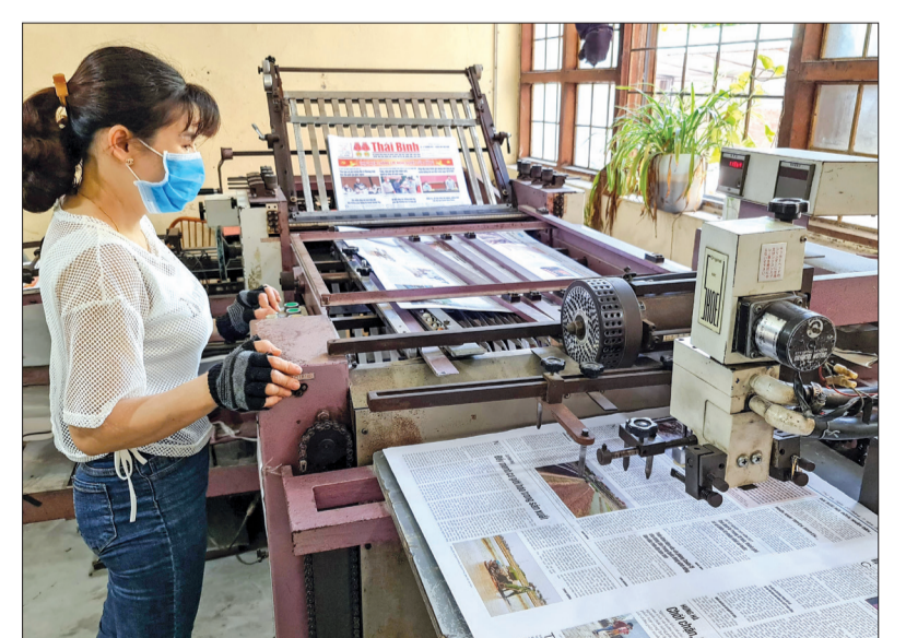
Nhờ có máy cắt, gấp tự động, năng suất lao động của công nhân tăng gấp 10 lần.
