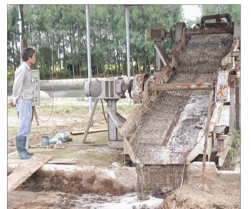
Hệ thống máy sàng lọc chất thải chăn nuôi lấy phân hữu cơ.
