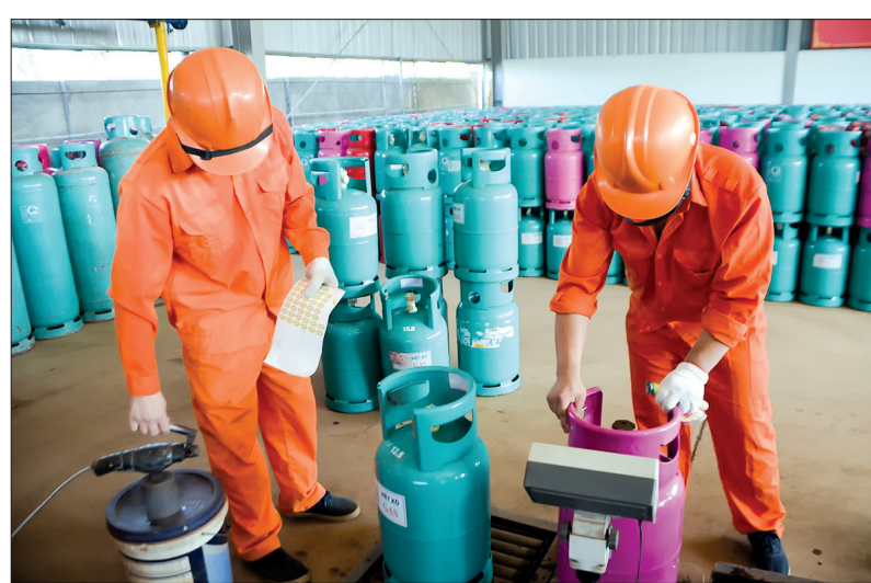
Kiểm tra áp lực bình gas trước khi xuất xưởng.
