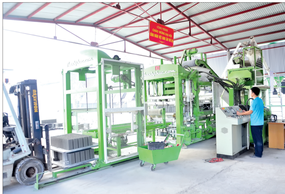
Hệ thống ép gạch không nung tự động của Công ty Cổ phần Vật liệu xây dựng Tiến Phong giúp nâng cao năng suất lao động.
