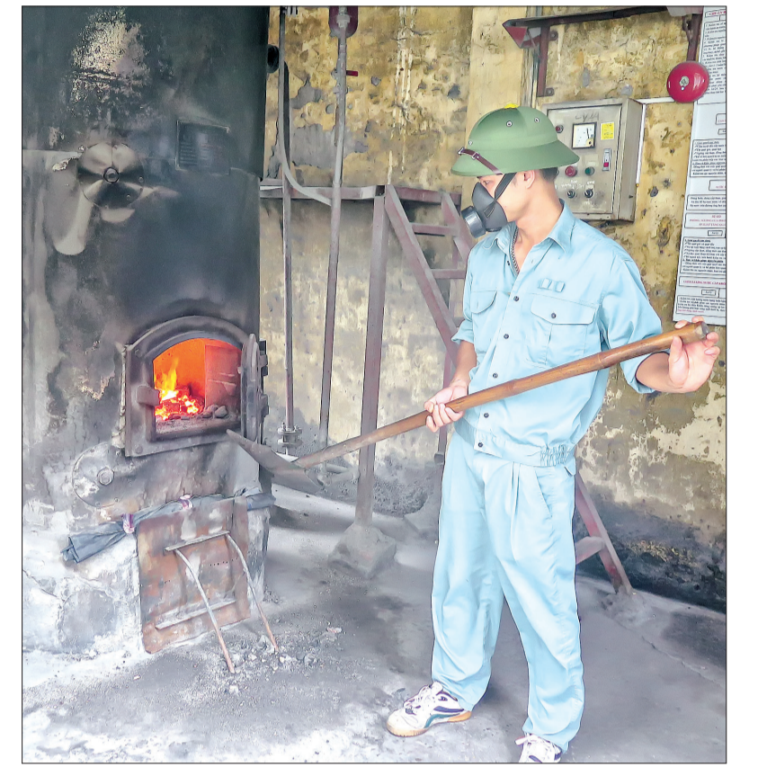
Các xí nghiệp dùng lò hơi bằng than để tạo nhiệt phục vụ sản xuất, tiết giảm một phần đáng kể sản lượng tiêu thụ điện năng cho doanh nghiệp.
