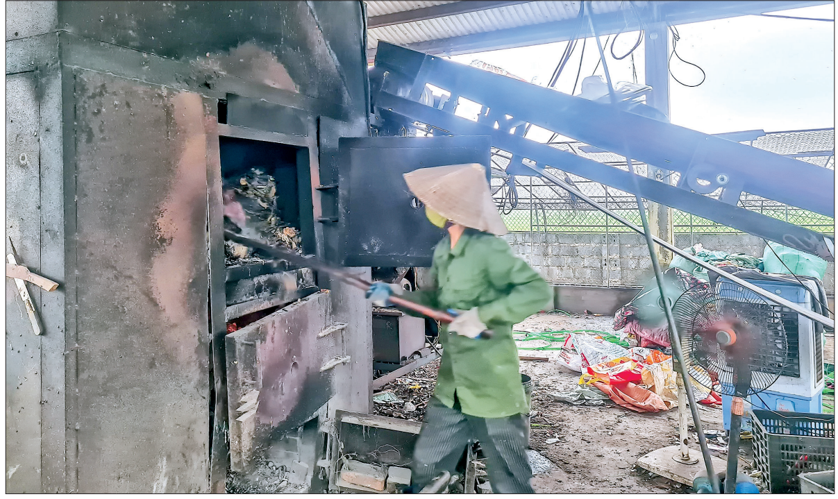
Lò đốt rác thải sinh hoạt xã Đông Xuân sau 10 năm hoạt động đã xuống cấp, thường xuyên hư hỏng.
