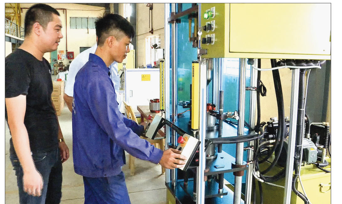
Công nhân vận hành hệ thống máy vào dây Stator tự động sản xuất động cơ điện.
