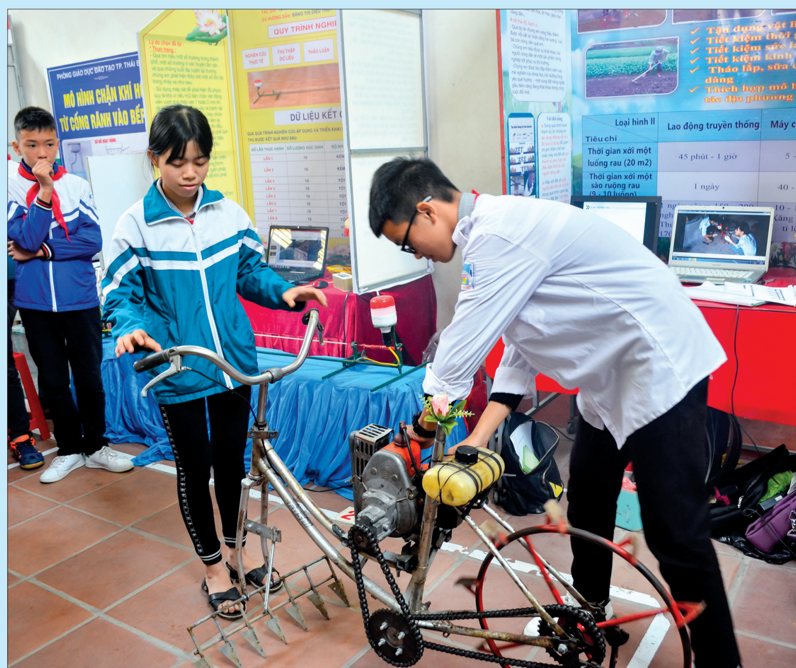
Dự án chế tạo máy xới đất từ động cơ máy cắt cỏ và xe đạp cũ.
