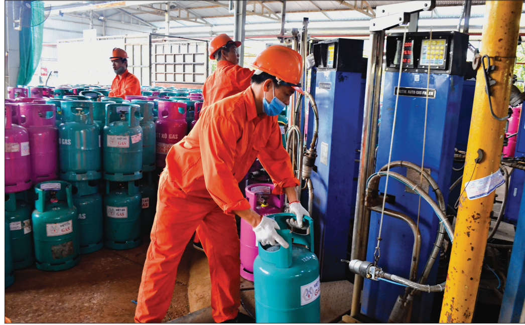
Dây chuyền sang chiết gas của Công ty Cổ phần Việt Xô gas Thái Bình.
