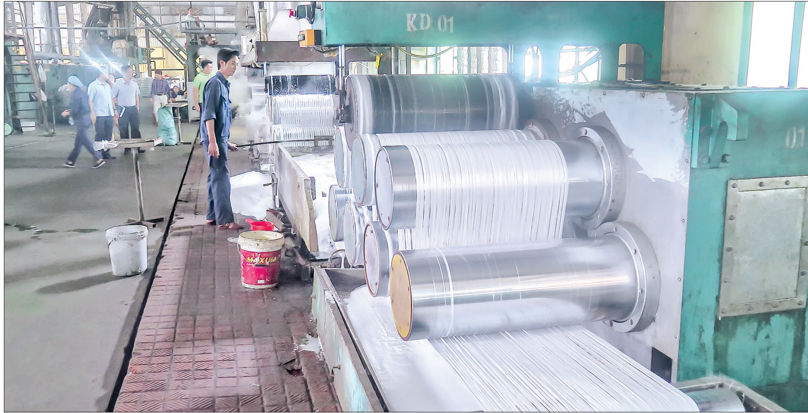
Sản xuất xơ Polyester từ chai nhựa phế thải ở Công ty TNHH Hợp Thành.
