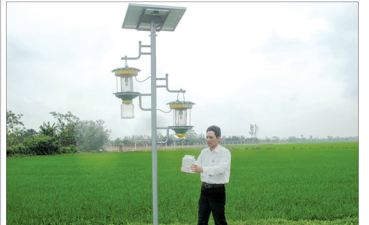
Mô hình lắp đặt bẫy đèn để theo dõi mật độ rầy.
