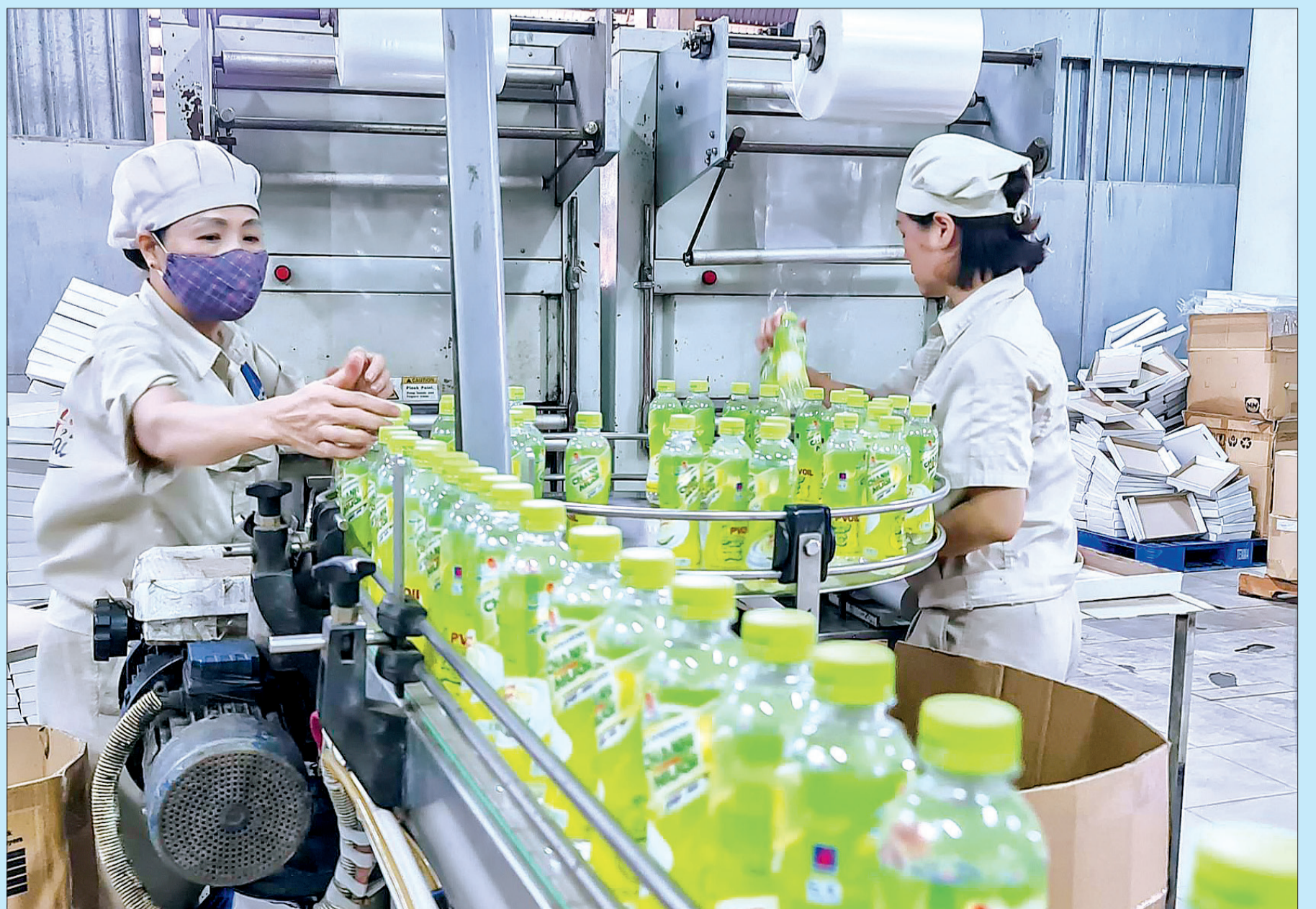
Dây chuyền sản xuất tự động giúp Công ty Cổ phần Dịch vụ Dầu khí Thái Bình giảm được 2 lao động thủ công, tốc độ sản xuất tăng gấp 4 lần.
