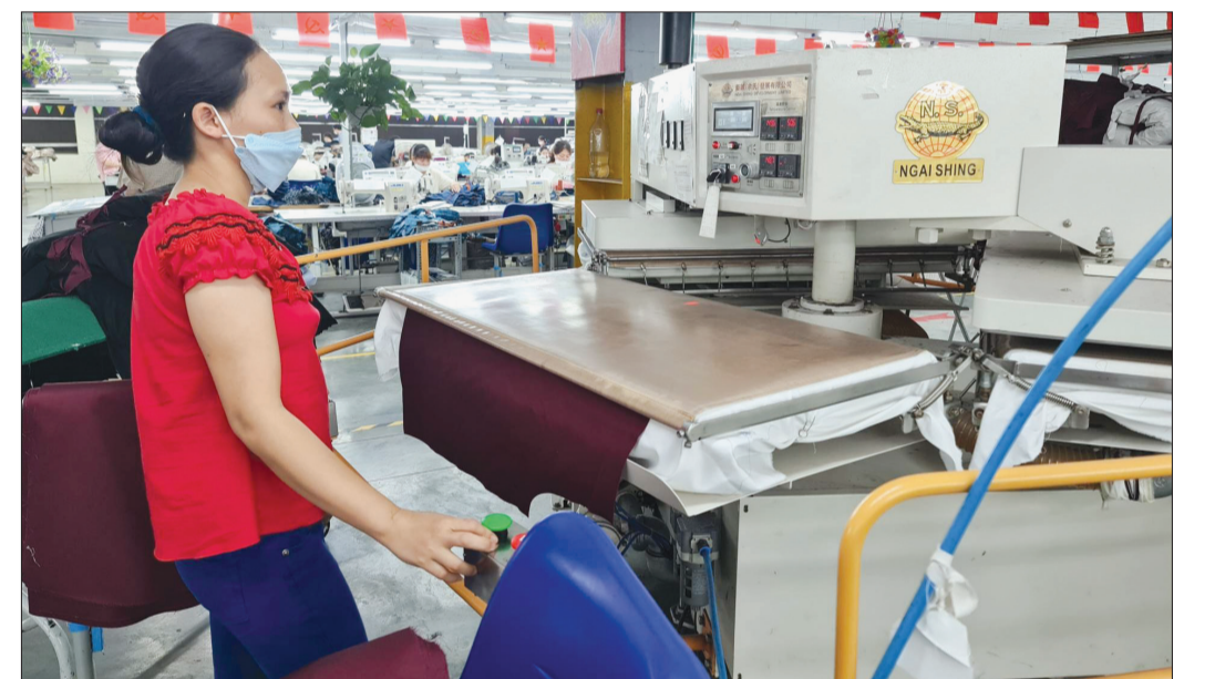
Máy ép tiêu hao điện năng lớn nhưng có công nghệ inverter nên hoạt động hiệu quả, tiết kiệm.
