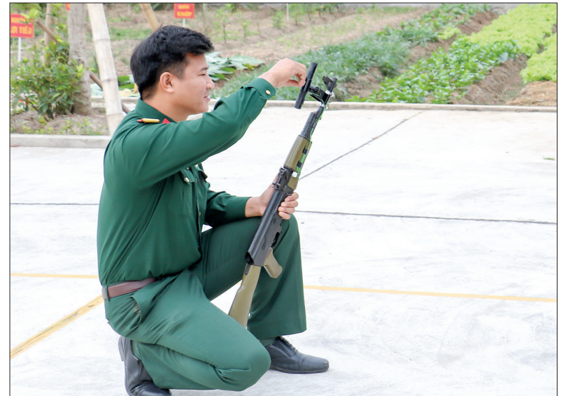
Thiếu tá Phạm Đức Thiện giới thiệu sáng kiến thiết bị kiểm tra đường ngắm và kiểm tra kết quả đạn bắn.
