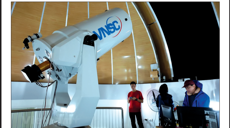
Đài thiên văn Hà Nội có một kính thiên văn quang học đường kính 0,5m, cấu trúc dẫn động đồng bộ với mái vòm điều khiển tự động, được trang bị một máy ghi nhận hình ảnh chuyên dụng và một bộ phân tích phổ chất lượng cao.
