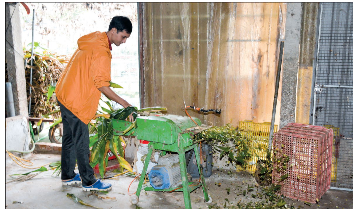
Máy thái cỏ gắn thiết bị trộn men do anh Nguyễn Xuân Huỳnh, Bí thư Đoàn Thanh niên Trường Trung cấp Nông nghiệp Thái Bình nghiên cứu, được nhiều gia trại áp dụng.
