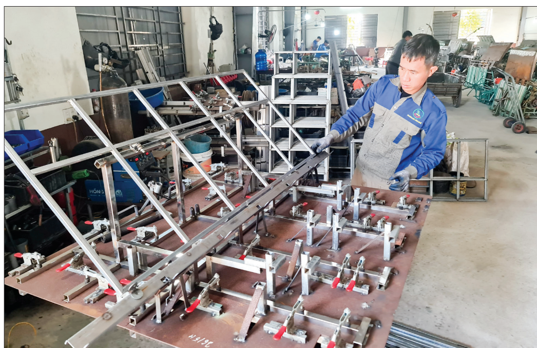
Công nhân Công ty TNHH Sản xuất và kinh doanh Đại Nghĩa chế tạo, lắp ráp máy cấy.
