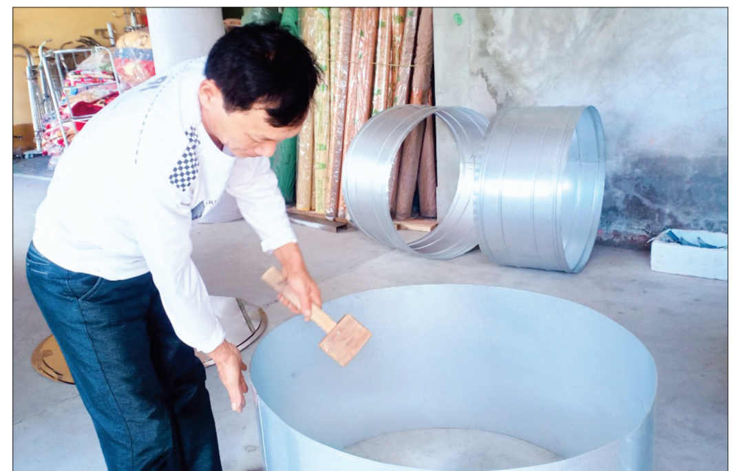
Ông Phạm Văn Dẫn, thôn Tam Đường, xã Tiến Đức (Hưng Hà) hoàn thiện công đoạn làm thùng tôn dựng thóc.
